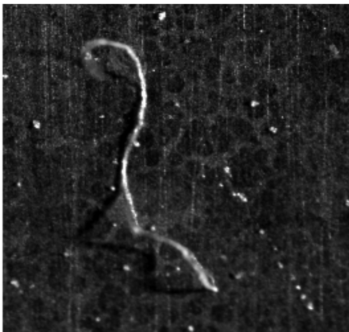
Whisker na vzorku z materiálu CuSn 8 s mezivrstvou Cu
